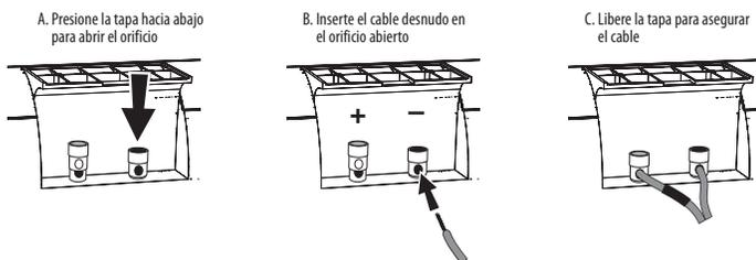
**IMPORTANTE:** Asegúrese de que los cables desnudos (+) y (-) no se rocen entre sí ni rocen al otro terminal. El roce de los cables podría provocar un cortocircuito que dañaría el receptor o el amplificador.
