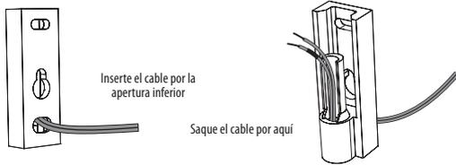
5. Si no va a introducir el cable del altavoz por la pared, insértelo por la porción de pared del soporte, tal y como se muestra en la imagen.
